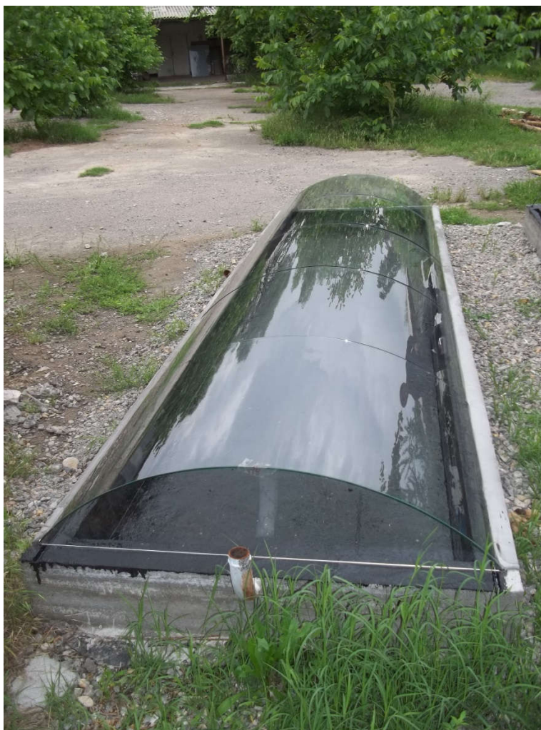
Рисунок 3.5- Общий вид опытного образца малометаллоемкой солнечной опреснительной установки с рабочей площадью 5.4кв.м.
