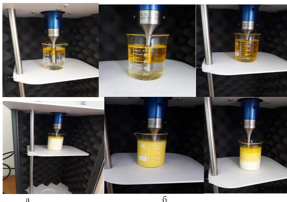
Рис.2. Ультразвуковая обработка водно-масляной композиции на основе сафлорового масла в соотношении воды и масла -20/80%
