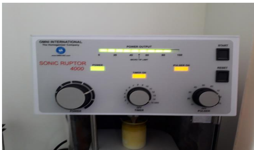
Рис.1 Ультразвуковой гомогенизатор Omni Sonic Ruptor 4000
