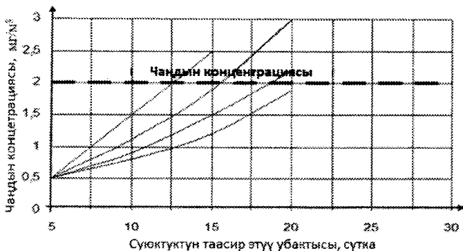
12-сүрөт – Технологиялык автожолду сугаргандан кийинки чанды басуу натыйжалуулугу [12]:
