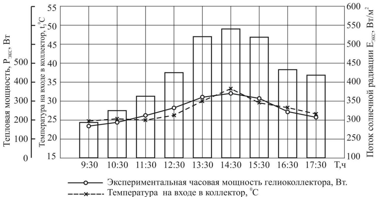
Рисунок 5П – Зависимость температуры воды на входе в коллектор  $t_3=f(T)$  и потока солнечной радиации [ $E_{\text{экс}}=f(T)$ ] от времени нагрева  $T$ .
