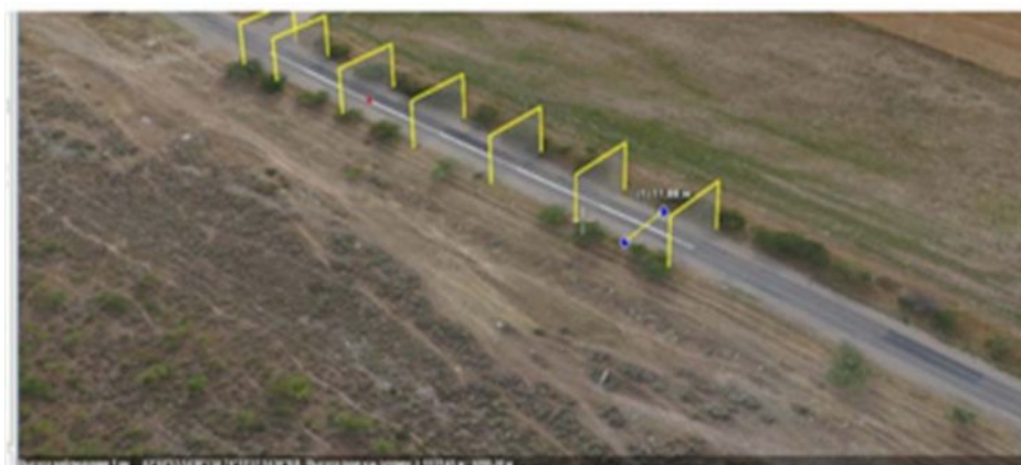
Рис.5. Построение поперечных профилей
