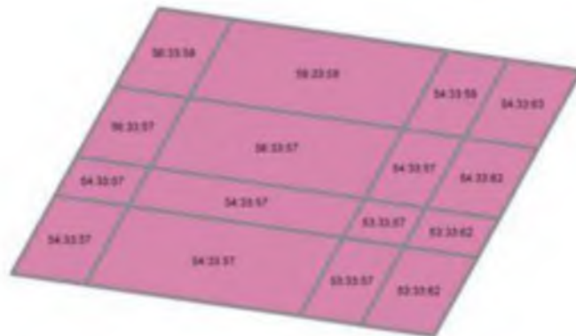
Рис.6. Структура объединенного слоя спектральных каналов диапазона VNIR
