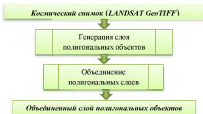
Рис.3. Алгоритм импорта космического снимка Landsat формата GeoTIFF в ГИС
