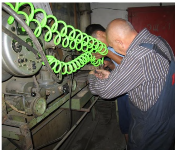
Восстановление и настройка систем подачи воздуха и охлаждающей воды
