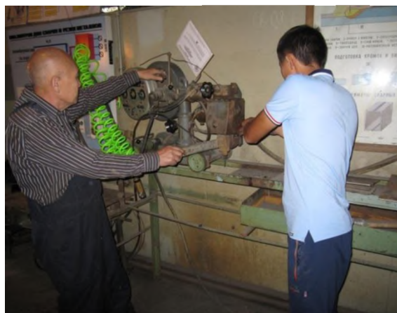
Ремонт систему перемещения и подъема плазмоторна
