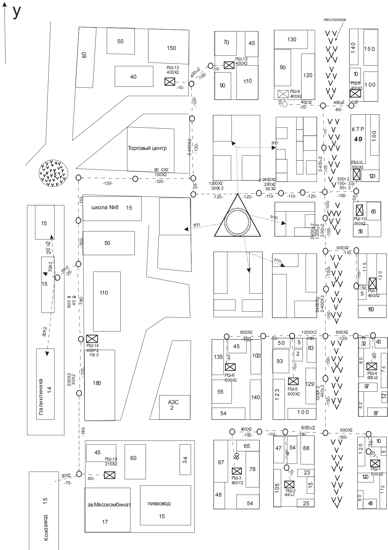
Рис.6. Шкафная система построения магистральной участок
