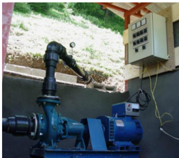
Рисунок 5 – МикроГЭС радиального течения с турбиной Френсиса 5 кВт
