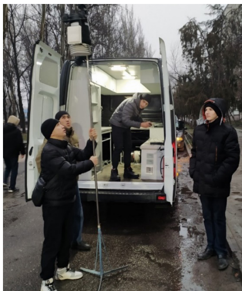
Рисунок 4 – Установка передвижной метеостанции Davis Vantage pro 2 для контроля за метеорологическими условиями
