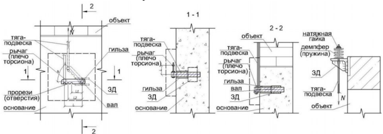
Рис. 4. Гаситель колебаний торсионного типа
