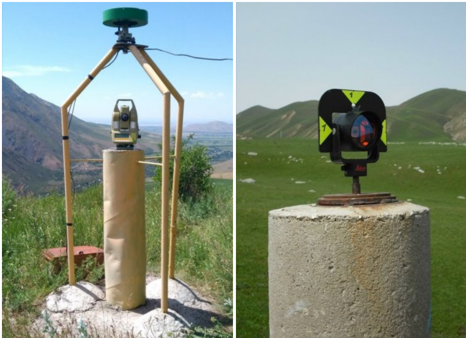
Рис. 2. Пример совмещенных GPS и линейно-угловых измерений на геодезическом репере слева; рефлектор на репере справа для отражения луча тахеометра и определения длины базовой линии
