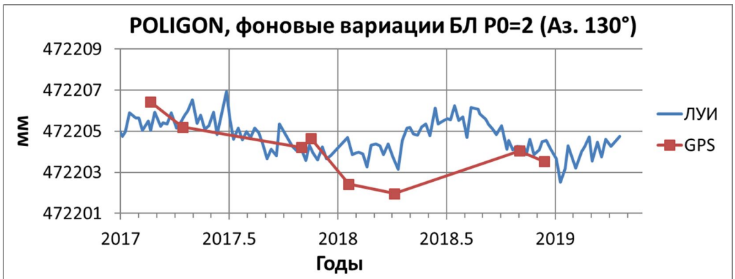
Рис. 3. Вариации длин БЛ P0=2 по данным еженедельных линейно-угловых измерений (ЛУИ), и по данным эпизодических 36-часовых GPS наблюдений (после полного цикла обработки программой GAMIT/GLOBK)
