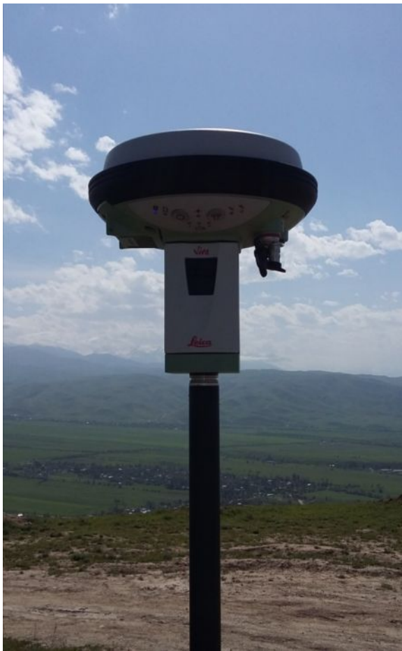
Рис.4. Спутниковое измерение создаваемой геодезической сети г.Бишкек
