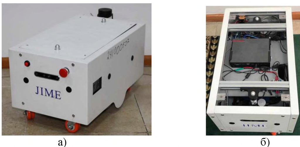
Рисунок 1. Экспериментальный образец транспортного робота; а – фотография робота с внешней обшивкой; б – фотография робота без верхней крышки
