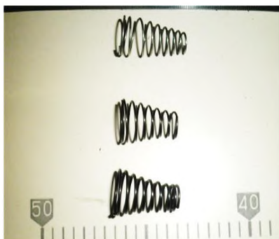
Общий вид цилиндрических пружин общей длиной 40мм с 10 витками
