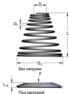
Рис.2. Расчетная схема витых конических пружин
