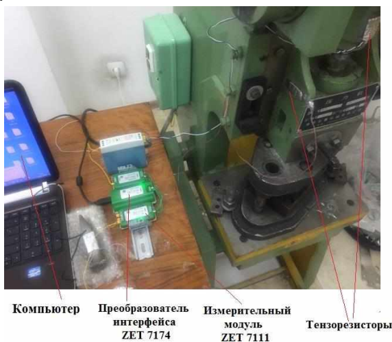
Рисунок 2. Стенд для экспериментального исследования кривошипного пресса
