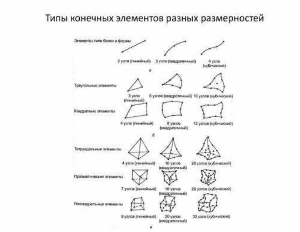
Рисунок 1. Типы конечных элементов в зависимости от различных размеров
