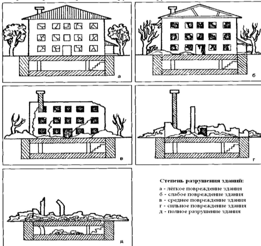
Рисунок 4. Степени обрушения, разрушения высотных зданий
