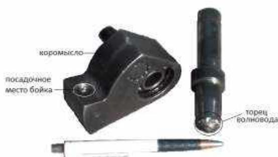
Рисунок 2. Поломки коромысла и волновода опытного образца перфоратора
