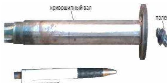
Рисунок 3. Поломка кривошипного вала перфоратора.
