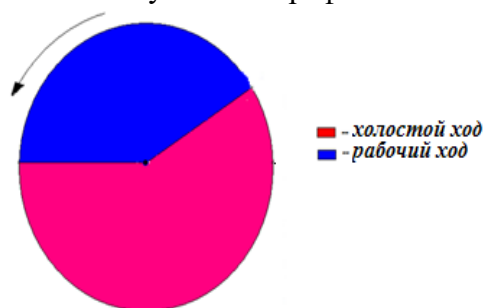
Рисунок 4 -Циклограмма движения кривошипа
