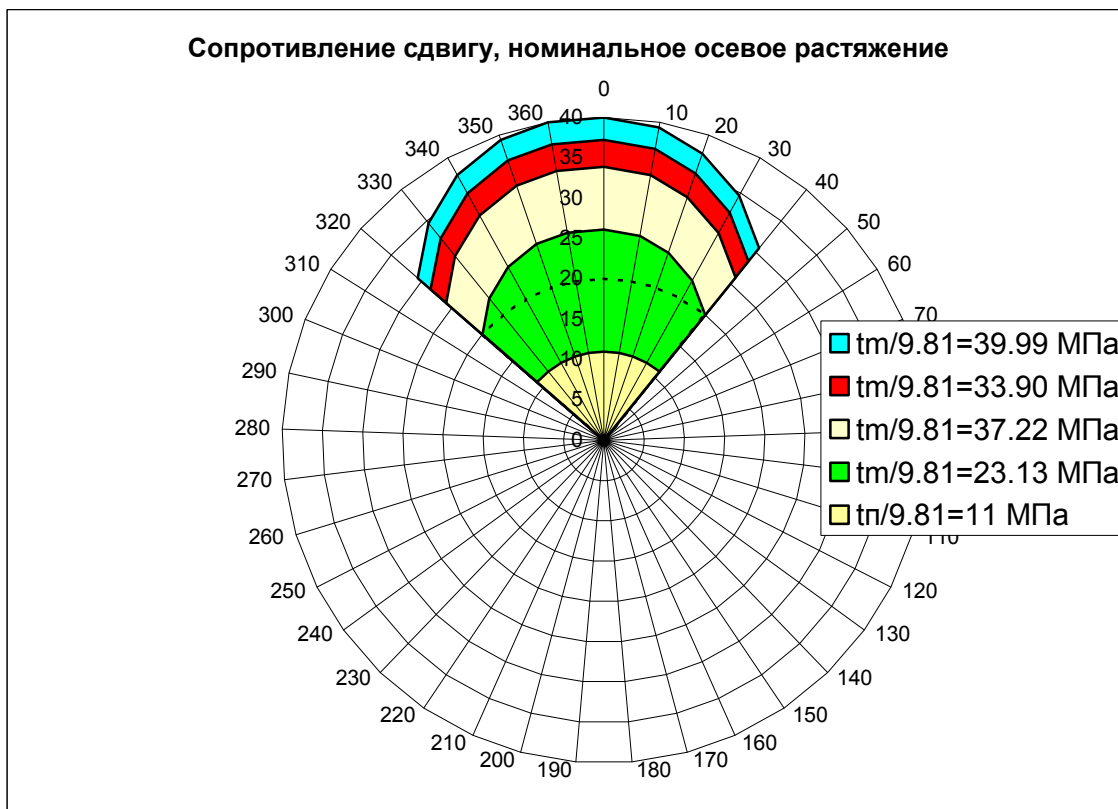
Рис. 3.11 Характер изменения S_{nl} по различным направлениям на главной площадке (площадке действия \tau_{max} ) после пластического растяжения.
