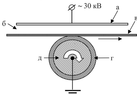
Рисунок 1 – Система обработки полимерных материалов барьерным разрядом:
