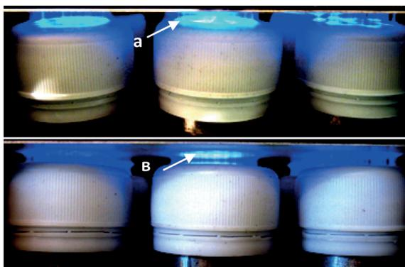
Рисунок 8 – Барьерный разряд между крышками и высоковольтным электродом: а – анодные пятна;
