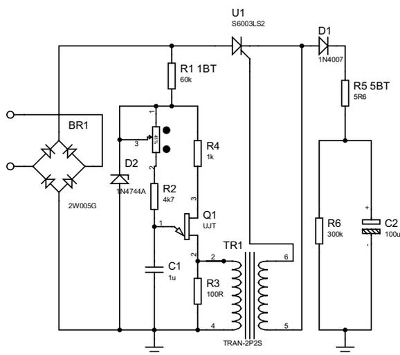
Рисунок 3 – Схема регулятора напряжения: U1 – силовой тиристор; Q1 – однопереходной транзистор; TR1 – трансформатор
