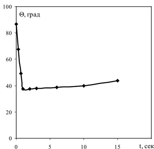
Рисунок 11 – Зависимость краевого угла смачивания от времени обработки
