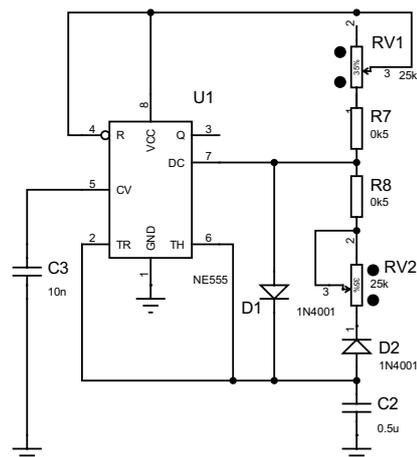
Рисунок 4 – Задающий генератор: U1 – таймер NE555; C2, RV1, RV2 – время, задающие конденсатор и резисторы
