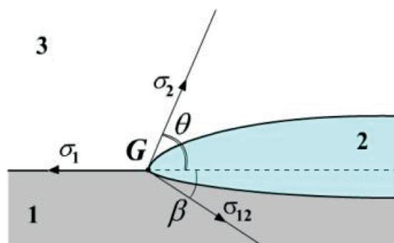
Рисунок 9 – Определение краевого угла смачивания.
