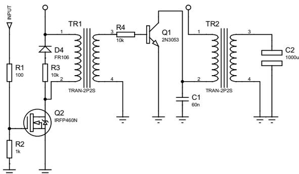
Рисунок 5 – Схема обратноходового преобразователя:
