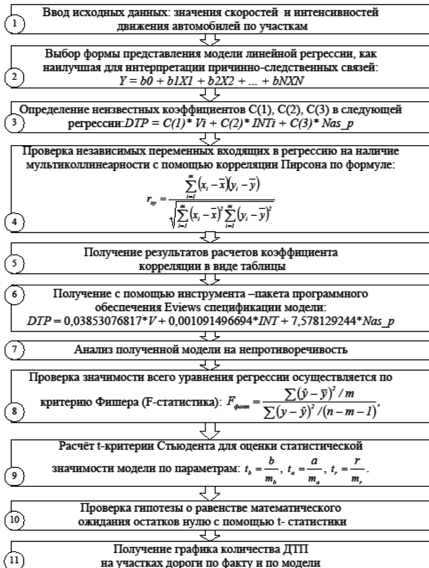
Рисунок 1 – Оперативная блок-схема (алгоритм) решения задачи влияния скорости и интенсивности движения на количество ДТП на автодороге Бишкек–Ош
