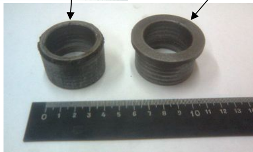
Рис. 4 Характерное место поломки в подшипнике скольжения а) шатун с поломанным подшипником б) шатун с целым подшипником
