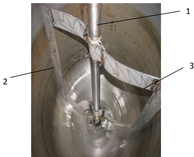
Рис. 2. Мешалка с лопастью: 1-вал мешалки; 2-боковые вертикальные лопасти; 3-верхняя горизонтальная лопасть
