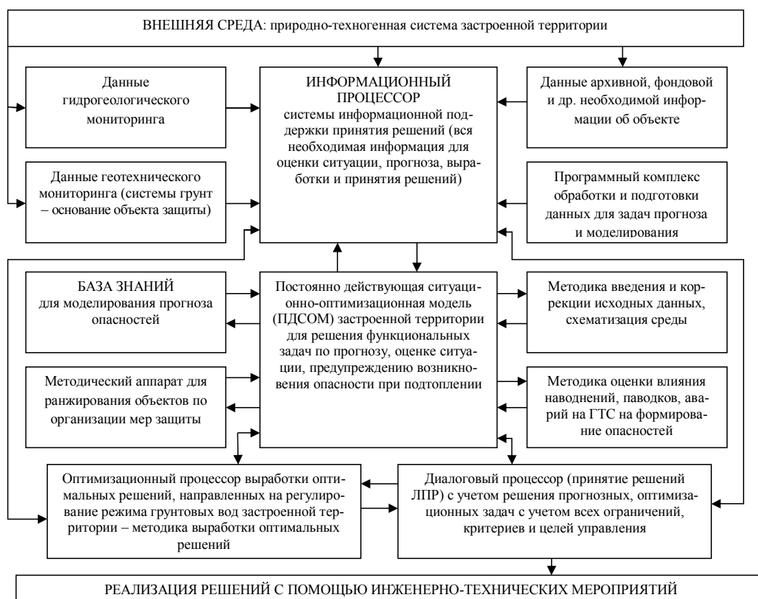
Рисунок 1 – Схема взаимосвязей элементов в системе поддержки принятия решений, направленных на предупреждение чрезвычайных ситуаций при подтоплении
