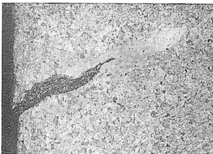
Рис.3 Раскатанный подкорковый пузырь (поперечное сечение).
