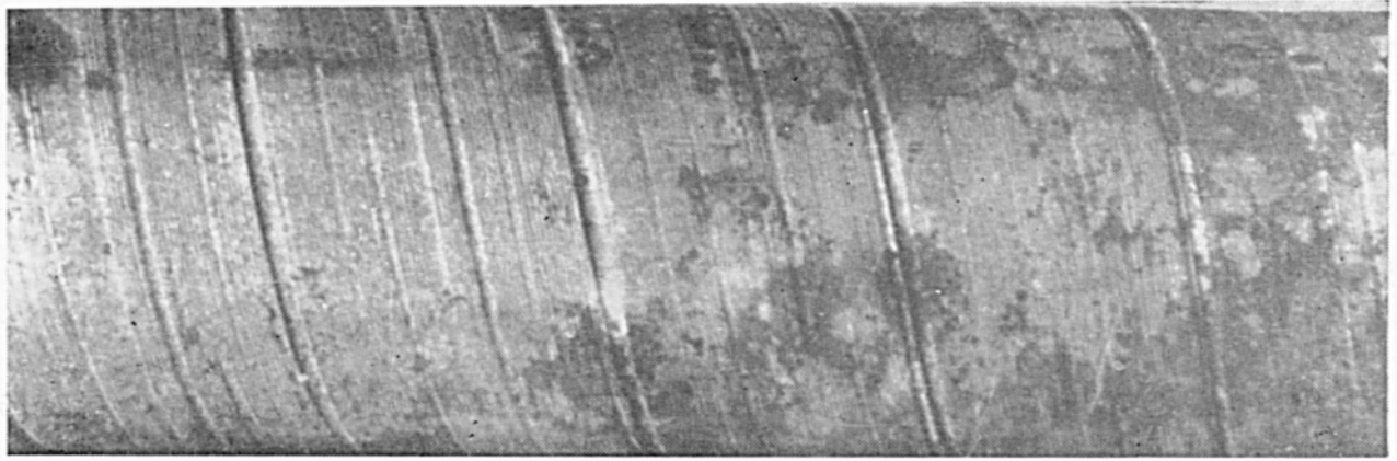
Рис.9 Канавки на поверхности трубы.
