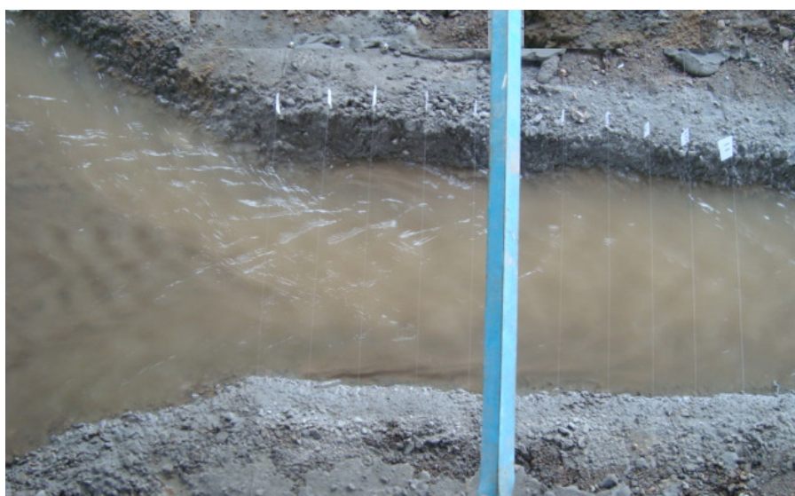
Рисунок 2 – Размещение начального участка зарегулированного русла относительно сопрягающего участка с симметричным размещением струенаправляющих дамб (на фото показан двухфазный поток жидкости при Q_{\text{рус}}=7,1 л/с, i=0,005 , \mu=0,19 г/л).
