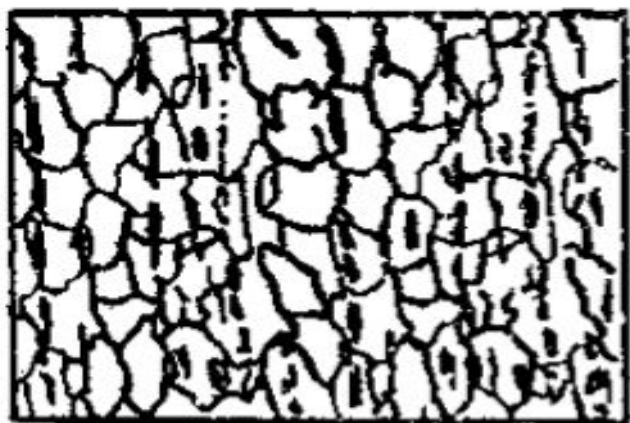
Рис.17 Алюминиевый сплав АК4 ( \alpha – твердый раствор и химические соединения – интерметаллиды) (схема)
