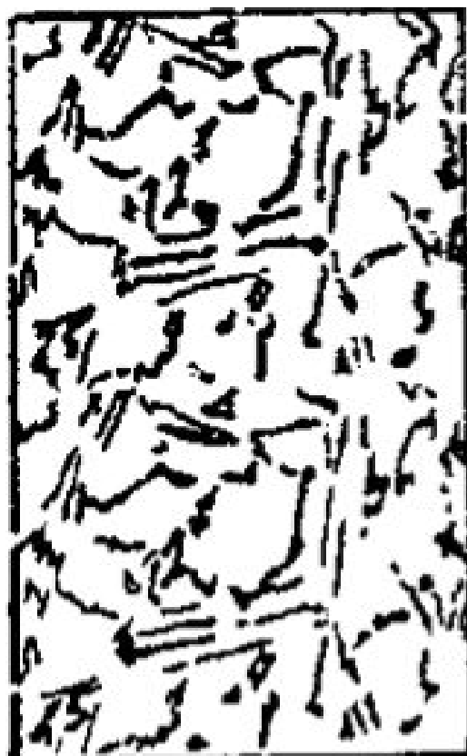
Рис.21 Схема структуры немодифицированного сплава АЛ4.
