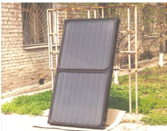
Рис. 4. Солнечный коллектор и установка для нужд горячего водоснабжения
