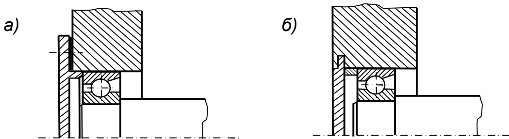
Рис. 4. Крышки подшипниковых узлов: а) привертная (торцевая), б) закладная
