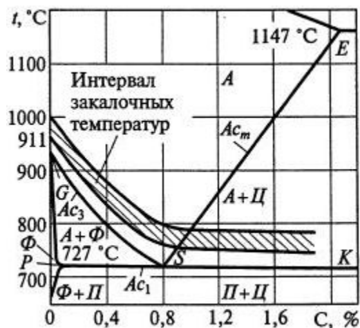
Рис. 10. Интервалы температур нагрева стали при закалке: А, Ф, П, Ц – структурные составляющие сплава: соответственно аустенит, феррит, перлит, цементит; GSE и PSK - линии вторичной кристаллизации на диаграмме Fe-C; Ac 1 , Ac 3 , Ac m – критические точки температур охлаждения
