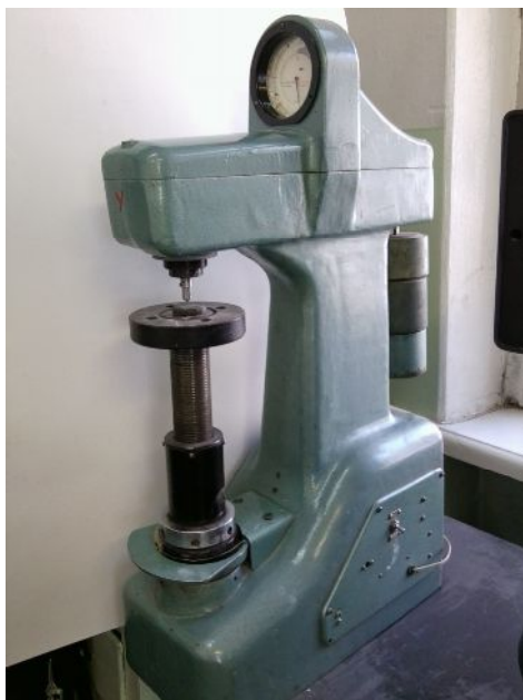
Рис. 3. Прибор ТК-2М для определения твердости по Роквеллу
