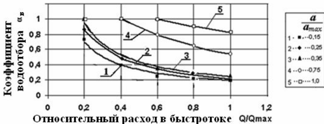
Рис. 4.28. Изменение коэффициента водоотбора \alpha_v с изменением расхода старшего канала и открытия затвора вододелителя.
