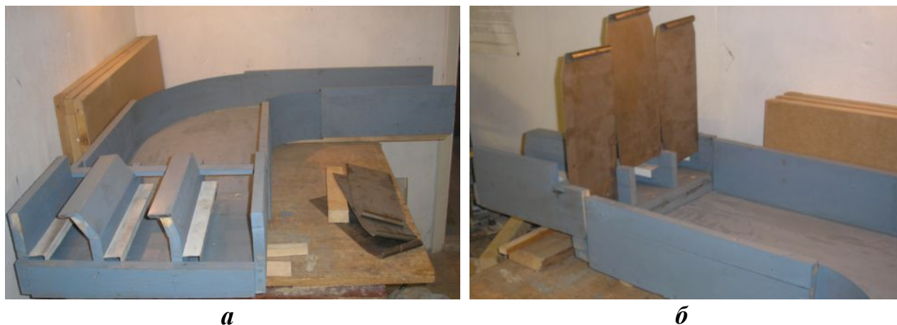
Рис. 4.21. Физическая модель вододеливателя для каналов со сверхбурным течением: а) со снятыми затворами; б) с установленными затворами.
