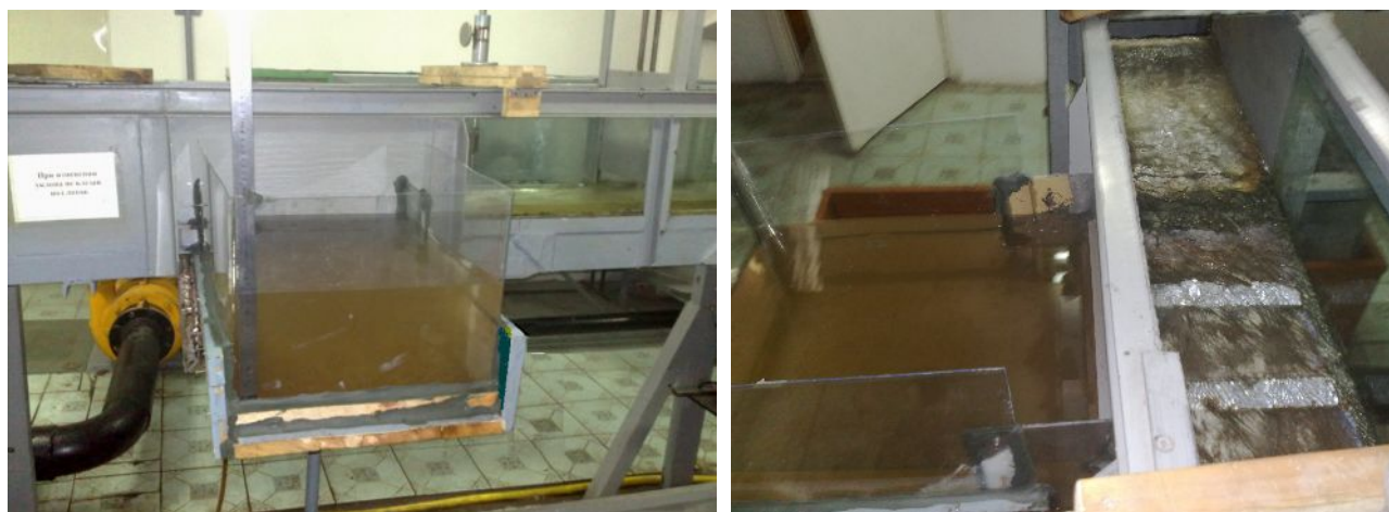
Рис. 3.19. Физическая модель ВСКСТ, установленная на гидравлическом лабораторном лотке: а) вид со стороны успокоительного колодца; б) вид сверху.
