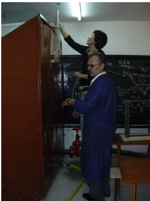
Рис. 3.22. Замер наполнений на мерном водосливе при входе в ГЛЛ.
