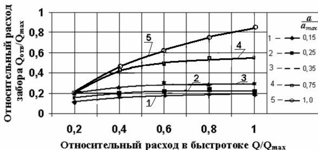
Рис. 4.29. Зависимость относительного расхода водоотбора Q_{отв}/Q_{max} от относительного расхода водоподачи по быстротоку Q/Q_{max} .
