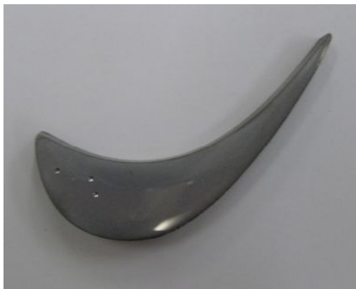
Рис. 1. Образец из стали 20X13 что в каждом случае (в зависимости от длины обрабатываемой поверхности) требует корректировки режима обработки.
