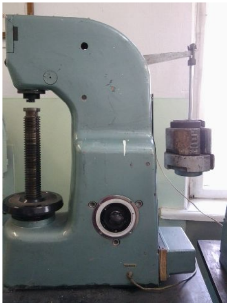
Рис. 2. Прибор ТШ-2М для определения твердости по Бринеллю
