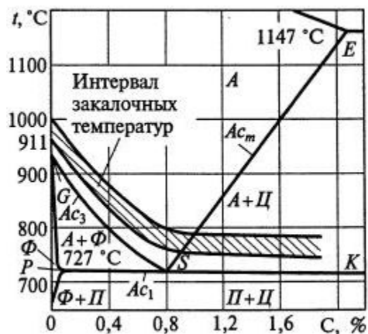
Рис. 10. Интервалы температур нагрева стали при закалке: А, Ф, П, Ц – структурные составляющие сплава: соответственно аустенит, феррит, перлит, цементит; GSE и PSK - линии вторичной кристаллизации на диаграмме Fe-C; Ас 1 , Ас 3 , Ас м – критические точки температур охлаждения
