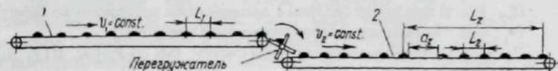
Рис.5. Транспортирующая система с групповым распределением объектов на 2-м транспортере и ротационным перегружателем
