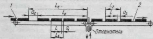
Рис. 2. Транспортирующая система с групповым распределением объектов на 1-ом транспортере и отсекателем
