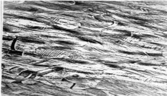
Рис. 1. Пластическая деформация при 600°C на 50% (x160).
