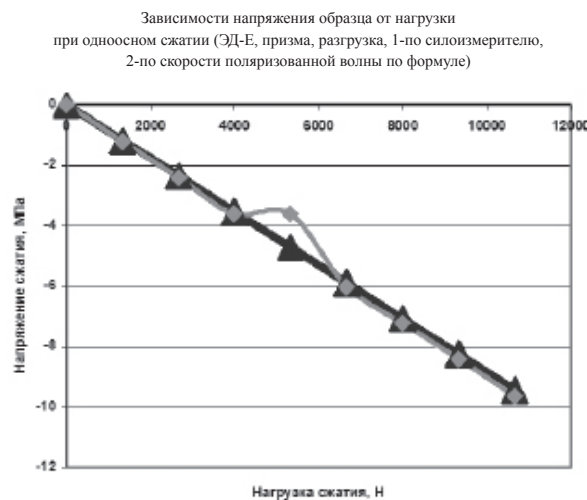
Рис. 5. Экспериментальная и ультразвуковая зависимости напряжения при разгрузке (ЭД – 6)
