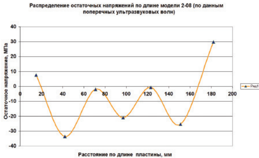
Рис. 2. График распределения остаточных напряжений по длине плоской модели 2-08
