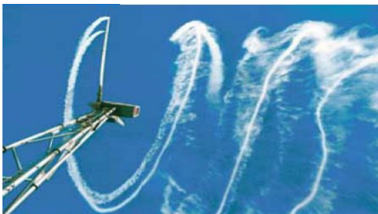
Рис.7.20 Аэродинамический след ветрового потока за плоскостью ветроколеса
