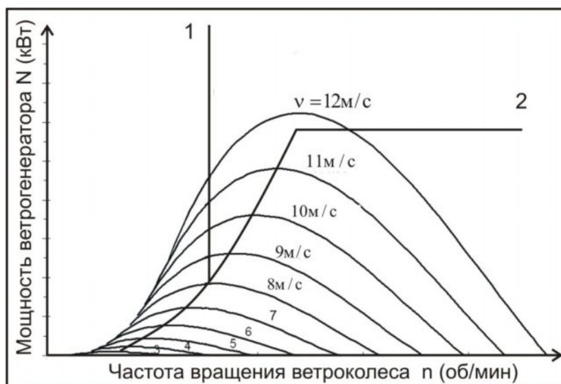
Рис.7.18 Мощность ветрогенератора в зависимости от частоты вращения ветроколеса
