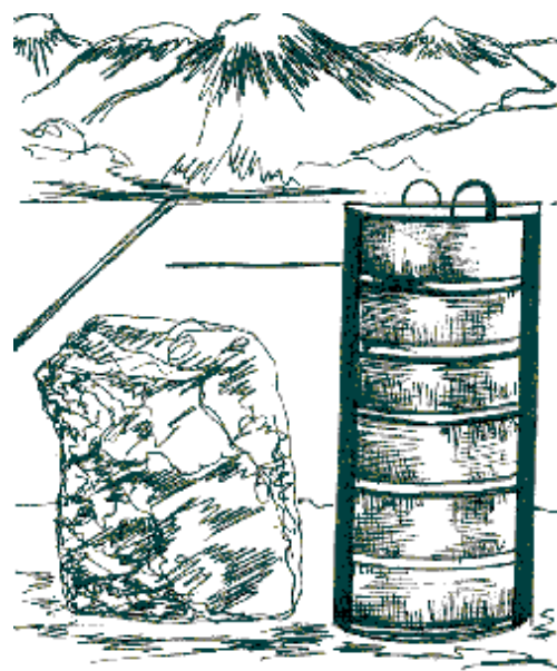
Образцы для исследования усадки бетона и форма для изготовления цилиндрических образцов. 65^{\circ}\text{C} , а ночью охлаждались до 20\text{--}25^{\circ}\text{C} . Установлено, что по толщине бетона образцов имеются значительные температурные пере-
