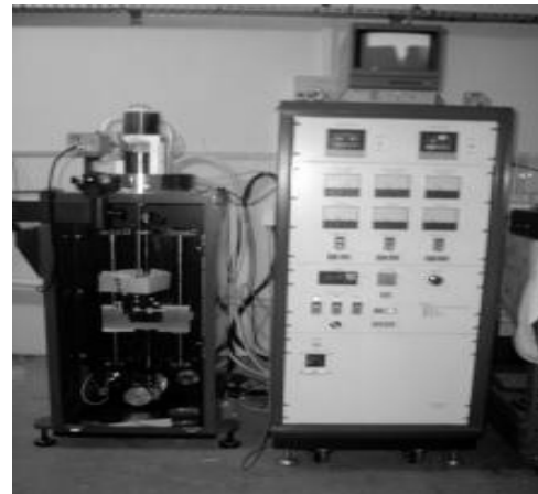
Рис. 2. Внешний вид экспериментальной установки Micro-Pull Down System S08-4521 (Japan) для выращивания монокристаллов в виде волокон методом микровытягивания.
