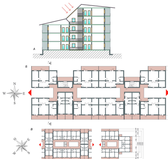
Рис. 2. Схема жилых домов средней этажности с малокомнатными квартирами с пассивной системой гелиотеплоснабжения: а – разрез плана дома широтной ориентации; б – фрагмент плана дома широтной ориентации; в – фрагменты плана дома, ориентированного на промежуточные румбы горизонта.
