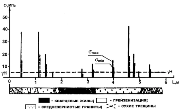
Рис. 4. Результаты измерения напряжений методом разгрузки по горизонтальной скважине на месторождении Восточный Коунрад на глубине 220 м (Центральный Казахстан) [2].
