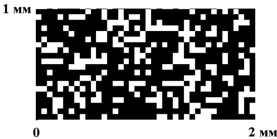
Рис. 1. Фрагмент расчетной области пористой волластонитовой керамики (светлые области – площадь, занятая порами).
