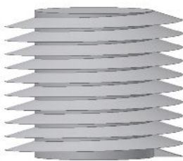
Рис. 12. Нестандартная винтовая поверхность (наружная)
