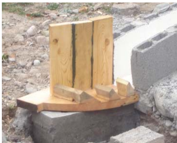
Рис. 1. Конструкция модели концевой части поверхностного водосброса Курпсайской ГЭС.
