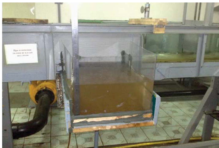
Рис. 3. Физическая модель ВСКСТ, установленная на гидравлическом лабораторном лотке (вид со стороны успокоительного колодца).
