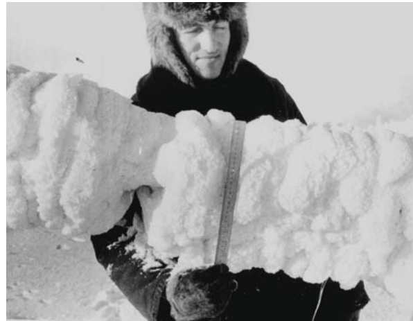
Рис. 2. Отложение плотной изморози на тросе опытного пролета (масса осадка 35 кг/м), Урал, Таганай гора, высота 1100 м.
