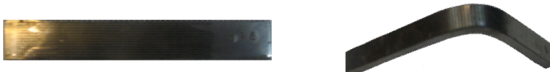
a) б) Рис.3.4. Заготовка ( a ) и согнутая деталь ( б )
