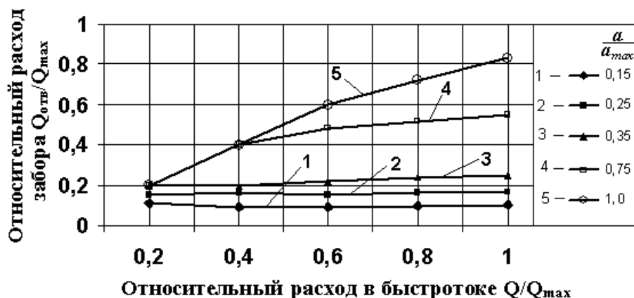
Рис. 5. Зависимость относительного расхода водоотбора Q_{отв}/Q_{max} от относительного расхода водоподачи по быстротоку Q/Q_{max} .
