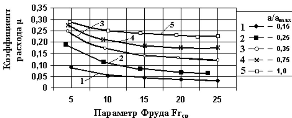
Рис. 3. Зависимость коэффициента расхода истечения через решетчатую плиту и боковые затворы ВКБРТ от кинетичности потока.
