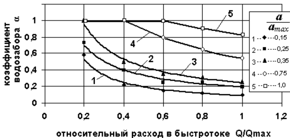
Рис. 4. Изменение коэффициента водозабора \alpha_e с изменением расхода старшего канала и открытие затвора вододелителя.
