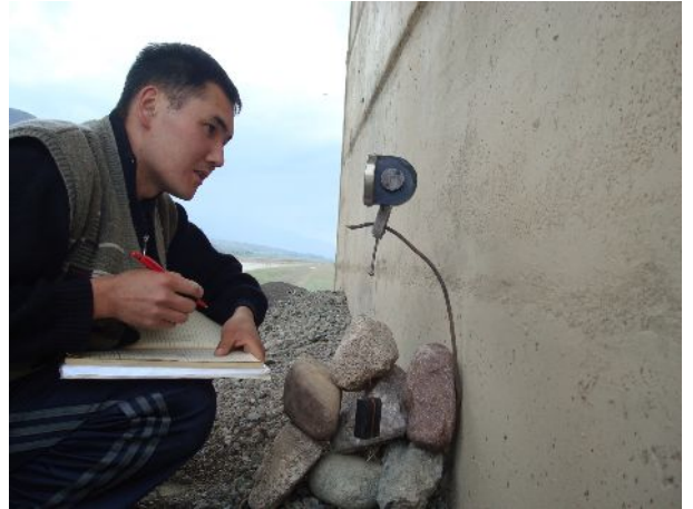
Фото 16. Запись результатов измерения прогибомера Максимова на второй опоре
