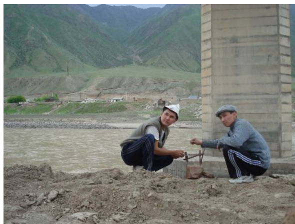
Фото 6. Установка прогибомера Максимова под вторым пролетом
