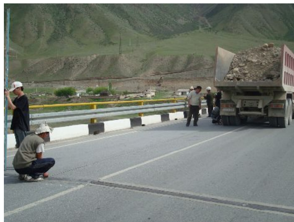
Фото 12. Проведение обмерных работ при загрузеии автотранспортом
