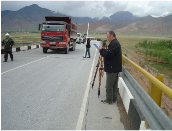
Фото 23. Первое загрузение 1-го пролета (1 грузенный автотранспорт). Нивелирование поверхности моста
