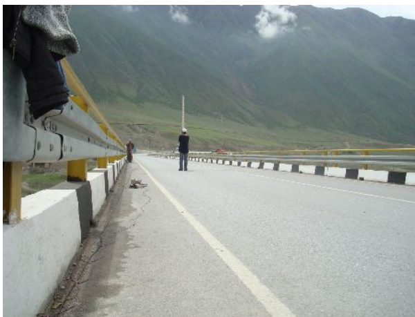
Фото 7. Нивелирование до загрузки
