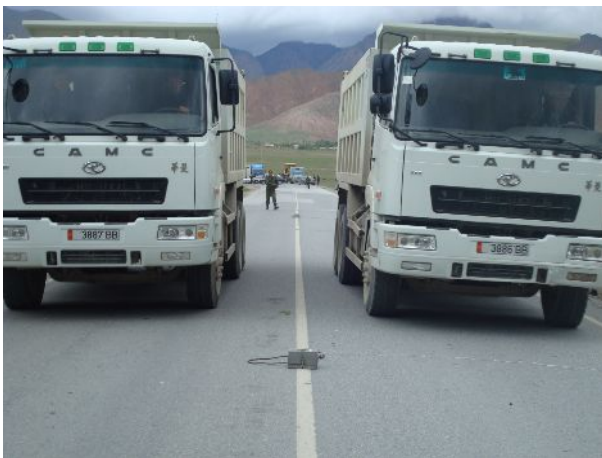
Фото 19. Запись сейсмоприемниками при движении двух автомобилей
