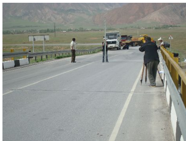
Фото 14. Определение остаточных деформаций первого пролета после разгрузеия (2 груженных автотранспорта)
