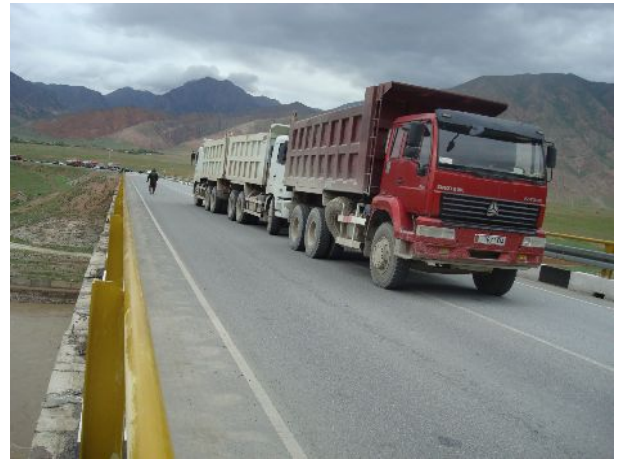
Фото 22. Вид 4-го пролета при третьем загрузении (3 грузенных автотранспорта)
