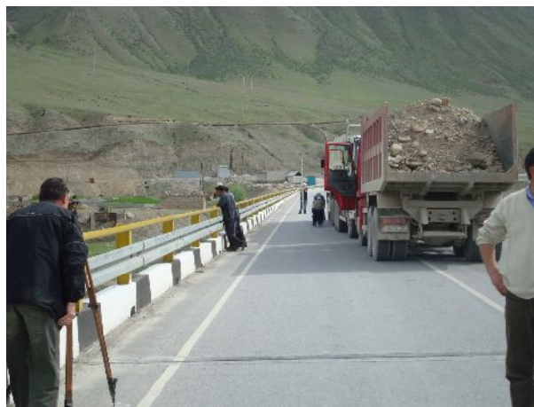
Фото 8. Нивелирование поверхности моста на втором пролете (2-е загрузке)
