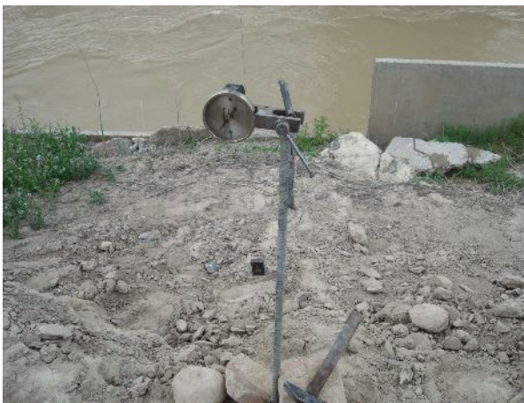
Фото 3. Прогибомер Максимова под пролетом 2
