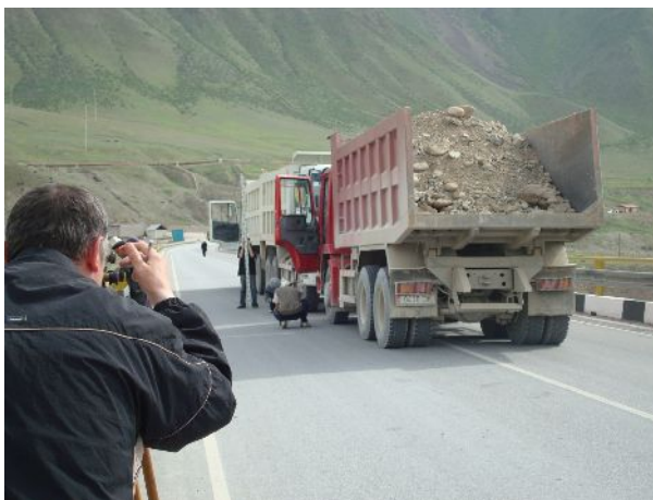
Фото 7. Нивелирование до загрузки
