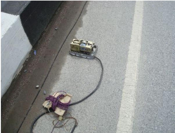
Фото 17. Вид сейсмоприемника при определении собственного колебания моста
