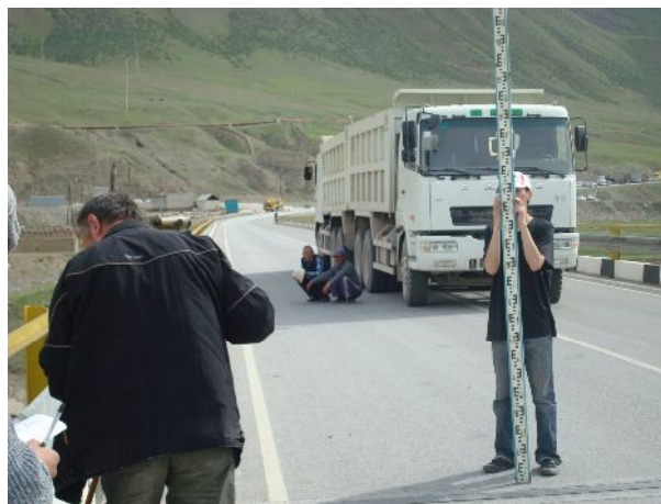
Фото 8. Нивелирование поверхности моста на втором пролете (2-е загрузке)
